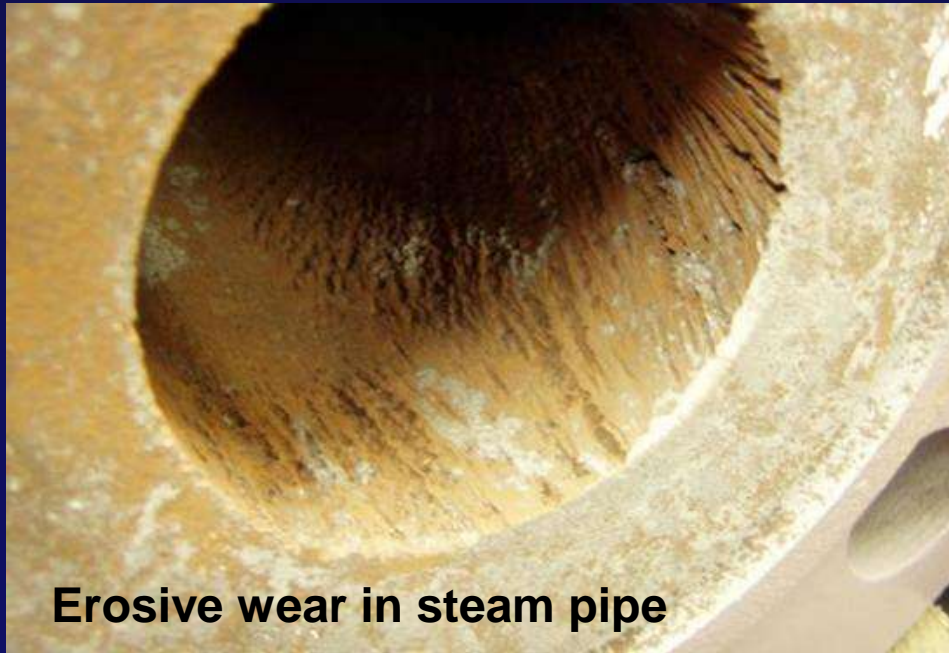
(a) 弯管受蒸汽气泡的冲刷
