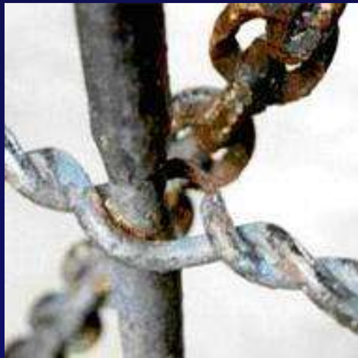
(b) 固定链条的微动磨损
