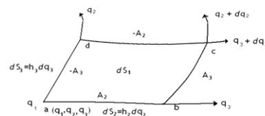
(3) 矢量  $\vec{A}(q_1, q_2, q_3) = A_1\hat{e}_1 + A_2\hat{e}_2 + A_3\hat{e}_3$  的旋度  $\nabla \times \vec{A}$  是一个矢量, 它在  $\hat{e}_1$  方向的分量  $(\nabla \times \vec{A})_1$  定义为: 以  $l$  记坐标面  $q_1$  上的面积元  $dS_1 = h_2 dq_2 h_3 dq_3$  的边界线, 其走向是关于  $\hat{e}_1$  成右手螺旋的, 则  $(\nabla \times \vec{A})_1 = \oint_l \vec{A} \cdot d\vec{l} / dS_1$ . 因为,
