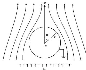
解：分析：以球心为原点，以  $\vec{E}_0$  方向为  $z$  轴取球坐标系。显然电势  $u(r, \theta, \varphi)$  与  $\varphi$  无关，并且  $r > b$ （而不是图中的  $r > b$ ）。现在的定解问题是
