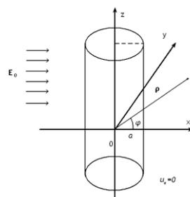
这里我们选取导体表面  $\rho = b$  为电势零点。第二个边界条件的右端第一项  $u_0$  是待定常数; 第二项是均匀电场  $E_0$  的电势  $-E_0 x = -E_0 \rho \cos \varphi$ ; 第三项是单独一个带电导体在远处所产生的电势, 记为  $u_2$ . 当  $L \rightarrow \infty$  时, 无穷多个点电荷在  $\rho$  处产
