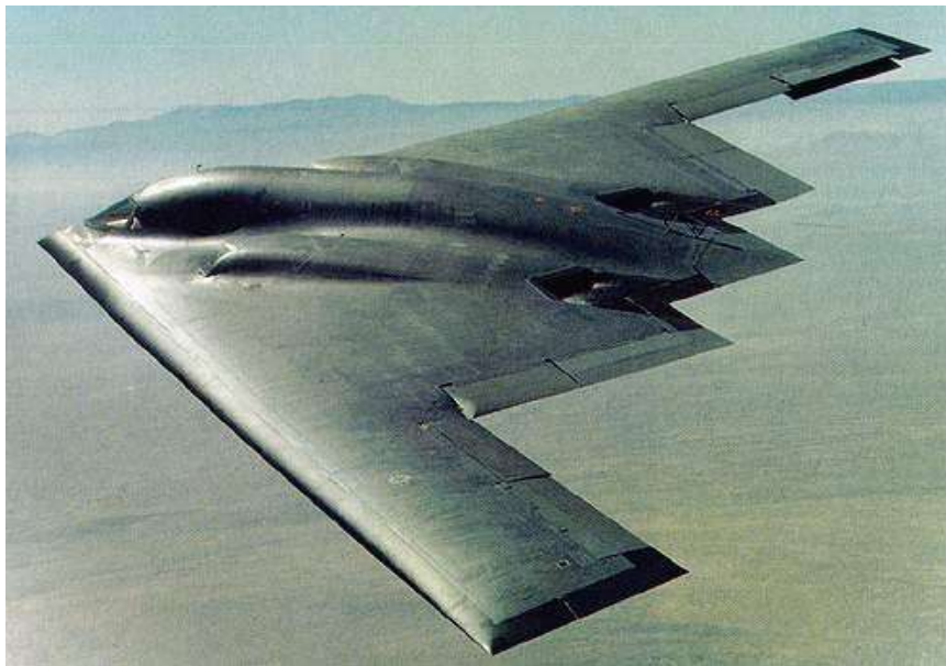
图 1-1 B-2A 隱形轰炸机表面吸波性好的 碳纤维复合材料
