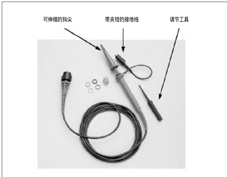
图 2-14 典型的通用电压探头及其标准附件。
