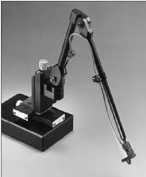
图 2-10. 用来探测小尺寸设备如混合电路或集成电路的探测台，探头架。
