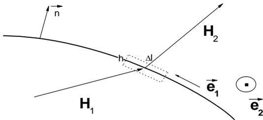
$$\oint \vec{H} \cdot d\vec{l} = \vec{H}_1 \cdot \Delta \vec{l}_1 + \vec{H}_2 \cdot \Delta \vec{l}_2 = \vec{j}_f \cdot \vec{e}_2 (h \cdot \Delta l) + \frac{\partial}{\partial t} (D \cdot \Delta l \cdot h)$$
