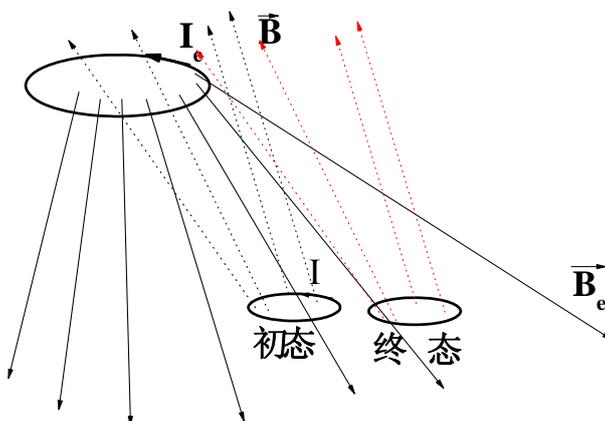
现在我们根据能量守恒来看一下 **保持电流不变** 条件下的“磁相互作用能”。与电偶极子（参考 [第 12 讲](#)）情况类似，考虑在外磁场中的一个磁偶极子，假设其平移一段距离，在这个过程中始终有一个外力与磁场对其的作用力大小相等方向相反， $\vec{F}' = -\vec{F}_B$ ，因此整个过程中外力对线圈的做功为
