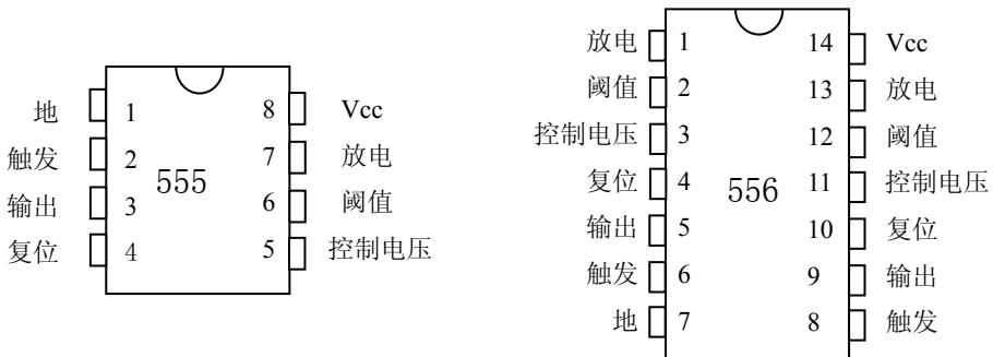
图 4.9 555、556 定时器电路
