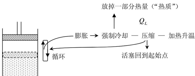
卡诺说明不能制造出 100% 效率的热机 → 热力学第二定律的推论
