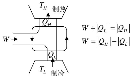
K 越大, 说明用很小的功能抽取很大的热量, K 反比于高低温热源的温差, 温差大, 效率越低。说明了为什么在东北很少有用空调制热, 因为室内外的温差很大, 制热效率下降。
