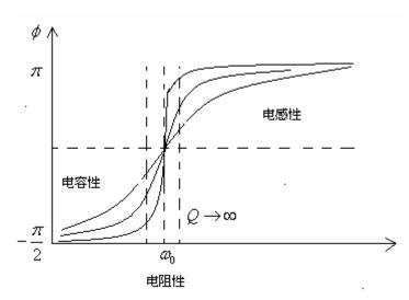
必有一个 $\pi$ 的相位跳跃。Q越大,这个跳跃越象一个阶跃函数。
