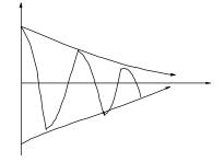
思考:最一般的解的形式应为 $\tilde{q}(t)=Ae^{-\alpha t}e^{i(\omega't+\phi)}$ ,其中 $A,\phi$  两个参数应由初始条件  $q(t=0)=q_0, i(t=0)=i_0$  给出。求解此时的电荷,电流随时间的变化,并讨论能量的转化——初始能量是否完全转化成热能?
